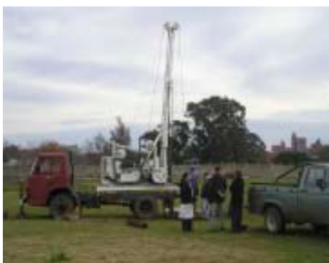
Fig. 24-25: Equipo perforador de extracción de muestras para caracterizar los rellenos de las canteras. Fuente: Laboratorio de Calidad Ambiental, IMM y Dirección Nacional de Medio Ambiente.
