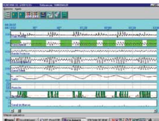
Figura 1. Ejemplo de una página de estudio con poligrafía respiratoria donde se registran las señales de flujo mediante sonda nasal y termistor, movimientos toraco-abdominales, saturación arterial de oxígeno, posición corporal y ronquido.
